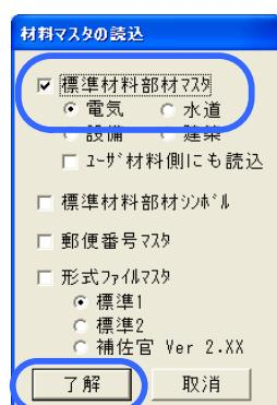
[標準材料部材マスタ]と、その下の[電気]に  チェックを付け[了解]をクリックします。
